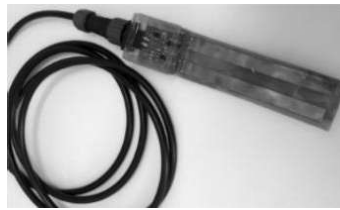
Figura 1. Sensor capacitivo de umidade de solo a ser testado.
