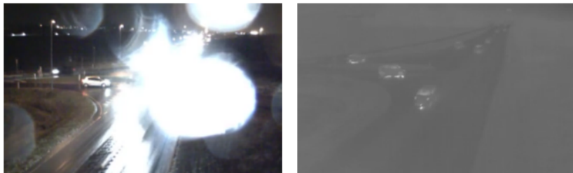
Figura 3: Mesma cena capturada com uma câmera convencional, à esquerda, e com uma câmera térmica, à direita. Extraído de [Alldieck et al., 2016]
